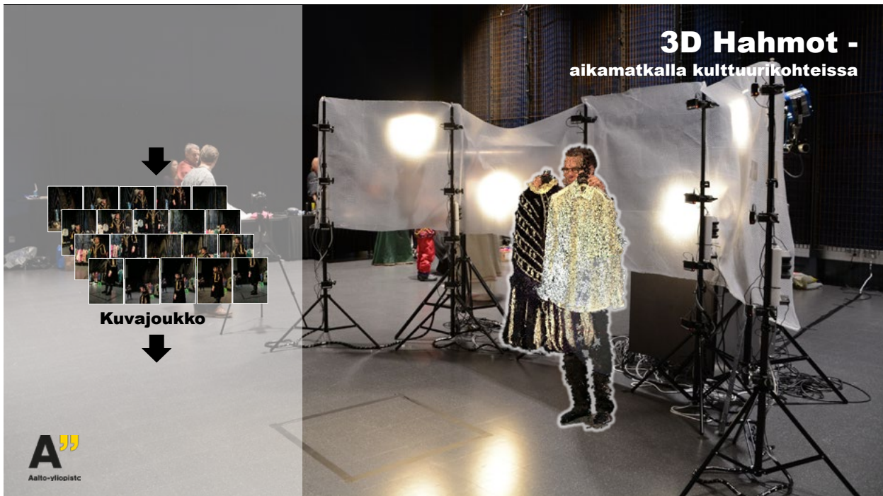
Kuva 2. 20 kameran kamerajärjestelmä. © JP Virtanen
