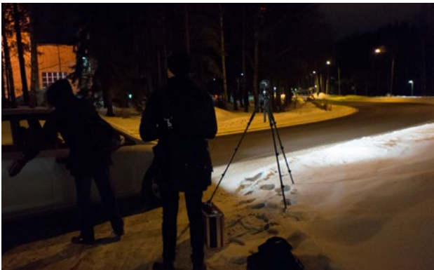
Kuva 2. Ryhmä kuvaamassa öistä tieympäristöä ja ensimmäinen luminanssikuvan ja tieympäristön mallin yhdistelmä.
