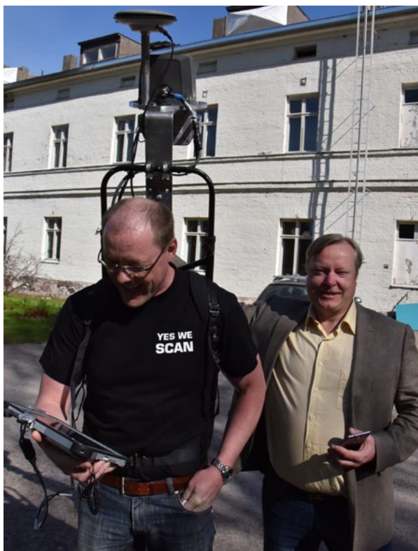
Kuva 3. Lapinlahden sairaala-alueen liikkuvaa laserkeilausta reppukeilaimella. © H. Hyyppä, A. Kukko, H. Siirala
