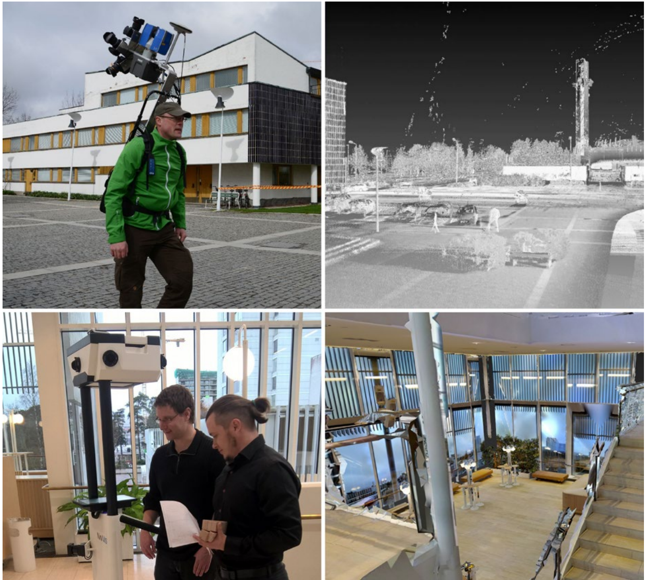
Kuva 2. Yläriivi: Mittausta reppukeilaimella ja kaupunkiympäristön pistepilvi. Alariivi: NavVis -sisätilamittaussysteemi ja pala rakennuksen sisätilamallia
