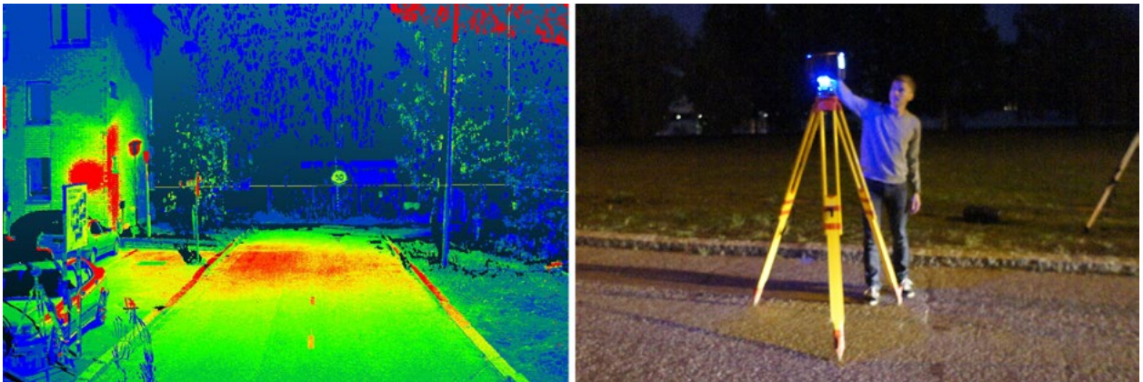
Kuva 3. Mittatarkka luminanssipistepilvi väritettynä valaistuksen voimakkuuden mukaan. Esimerkiksi valaisimen talon seinään tuottama kirkas alue on selvästi erotettavissa. Tieympäristöstä tuotettiin 3D-pistepilvi laserkeilaamalla.
