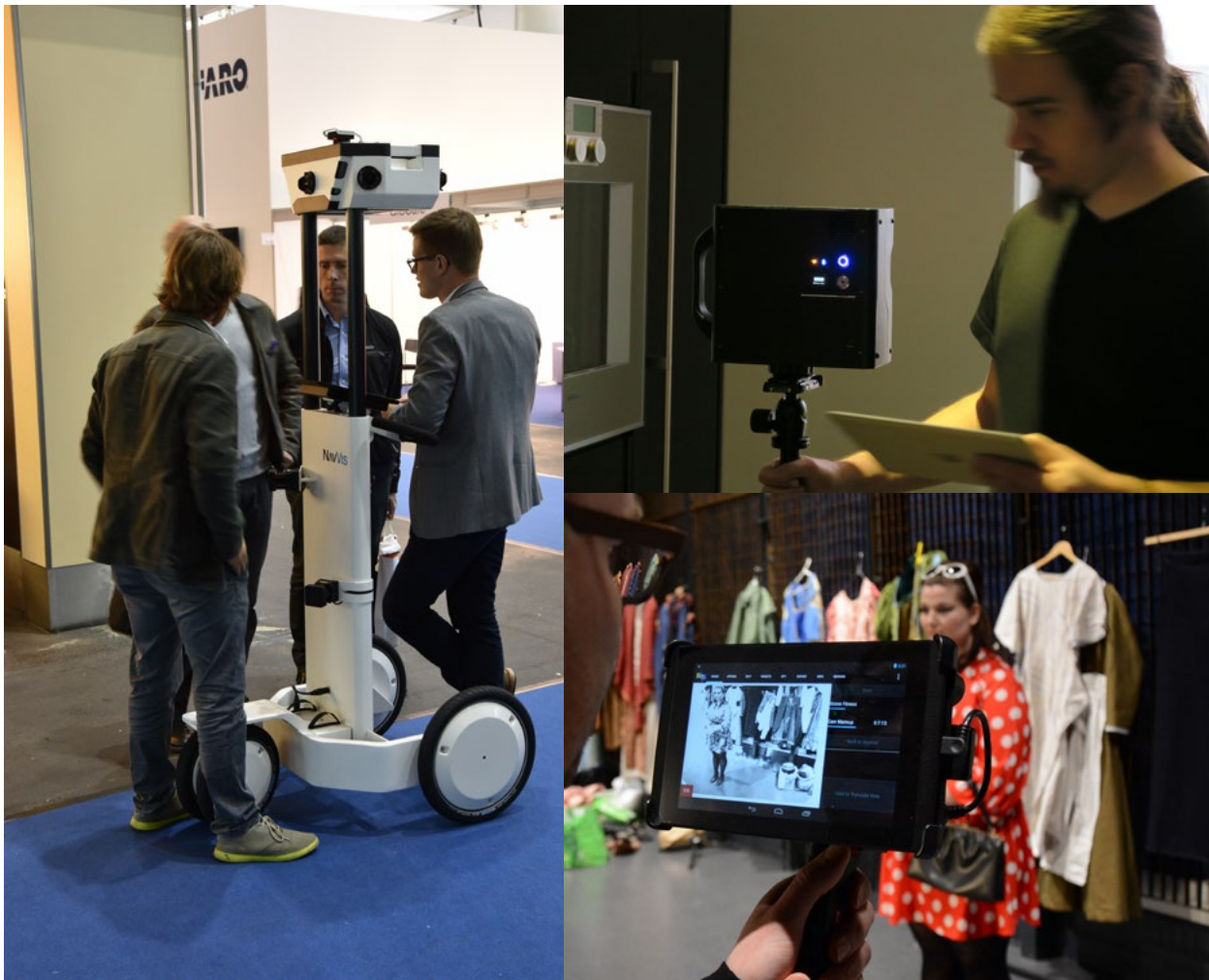
Kuva 10. NavVis, DPI-7 ja Matterport. © H. Hyyppä
