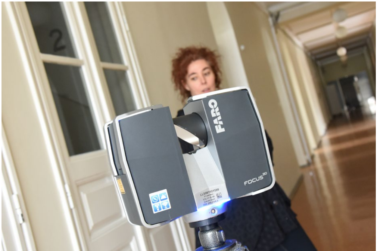
Kuva 8. Maalaserkeilaimet tuottavat tarkkoja pistepilviä.
