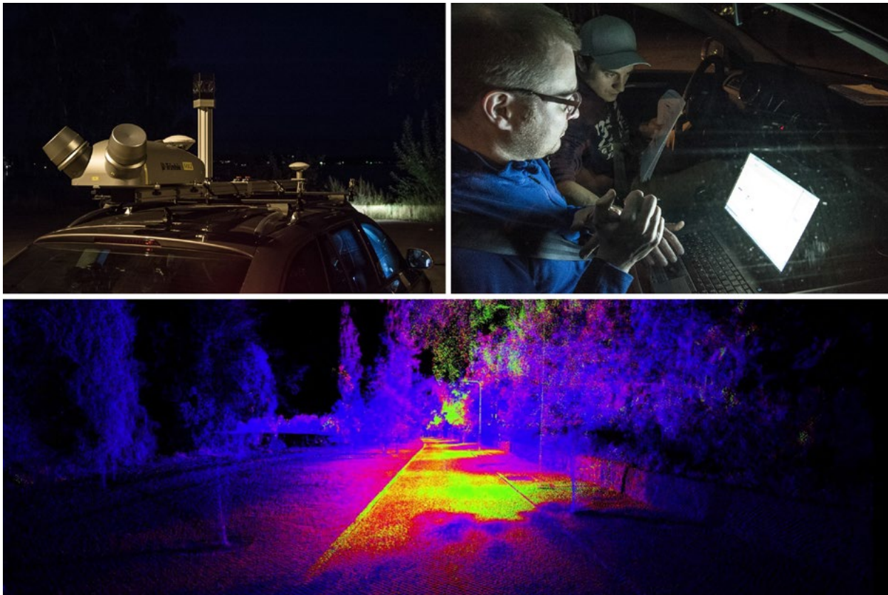
Kuva 4. Trimble MX2-laitteisto, jota säädetään luminanssikuvausta varten. Yhdellä mittauksella tuotettu pistepilvi, jossa pisteet on väritetty luminanssiarvon mukaan.
