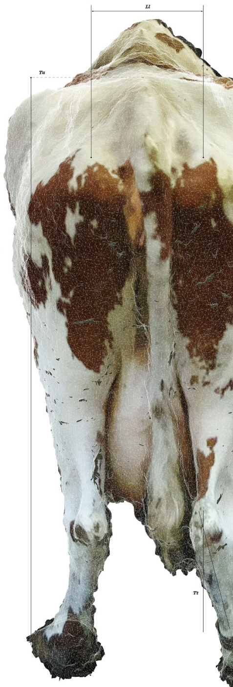
Kuva 1. Monikamerajärjestelmällä mitattu teksturoitu 3D-malli lehmästä. Mallista voidaan laskea mittoja, kuten takakorkeus ( T_a ) lonkkakyhmyjen kohdalta, lantion leveys ( L_l ) tai takajalkojen asento takaa ( T_t ).
