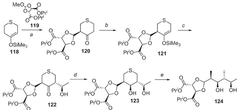
**Scheme 14** a  $\text{ZnCl}_2$ ,  $\text{CH}_2\text{Cl}_2$ , 55, 21 h, rt; b LiHMDS, THF, TMSCl, 1 h,  $-78^\circ\text{C}$  to  $>0^\circ\text{C}$ ; c  $\text{CH}_3\text{CHO}$ ,  $\text{TiCl}_4$ ,  $\text{CH}_2\text{Cl}_2$ , 5 min,  $-78^\circ\text{C}$ ; d Et<sub>2</sub>BOMe, NaBH<sub>4</sub>, THF–MeOH, 1 h,  $-78^\circ\text{C}$ ; e Raney Ni, IPA, 24 h,  $70^\circ\text{C}$ .
