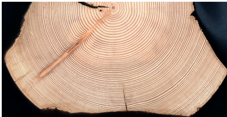
Kuva 1. Qwenselin talosta sahalla otettu näyte. Sahanäytteistä on mahdollista mitata lustojen leveyksiä usealta sektorilta mikä parantaa ajoituksen onnistumisen mahdollisuuksia. Kuva: Tuomo Wallenius.
